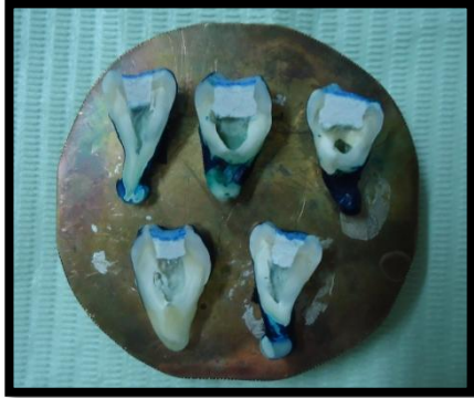
Fig. 105. Preparación de la muestra para recubrimiento de oro.
