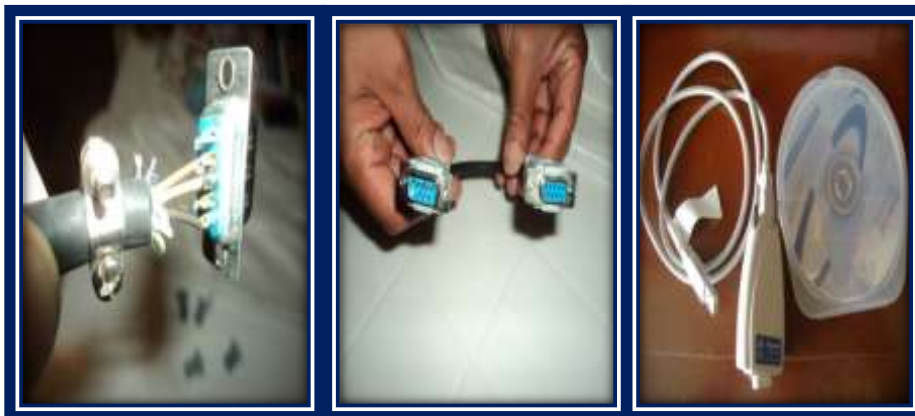
Figura 5.10. Cables acoplados para la interface con el PLC
