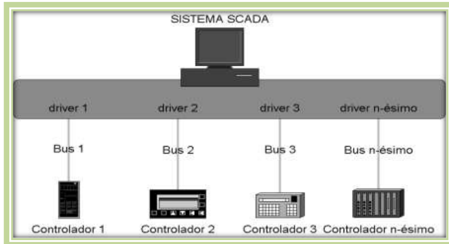
Figura 4.11. Integración de Controladores específicos.
