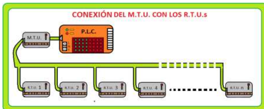
Figura 4. 8 Conexión del M.T.U. con los RTU's.
