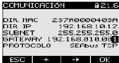
Figura 4.11: Ejemplo de visualización con valores introducidos. Fuente: Documento, Manual del SENTRON PAC 3200
