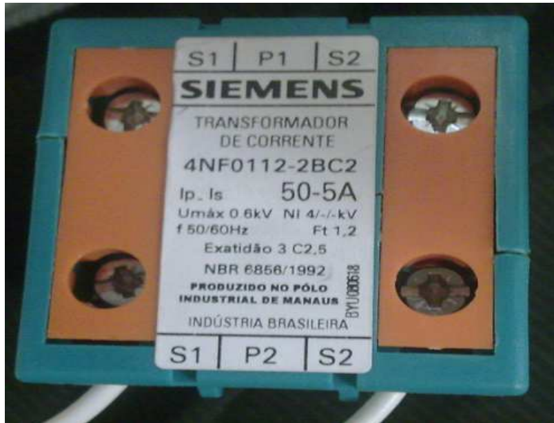
Figura 4.34: Transformador de corriente de 50 a 5 A Fuente: Autores del documento
