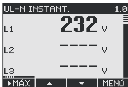
Figura 4.4: Visualización de la tensión medida con el tipo de conexión 1P2W Fuente: Documento, Manual del SENTRON PAC 3200
