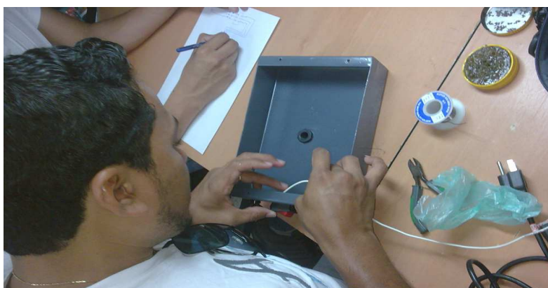
Figura 4.21: Conexión de líneas de alimentación on / off, protecciones, entradas y salidas del SENTRON PAC 3200
