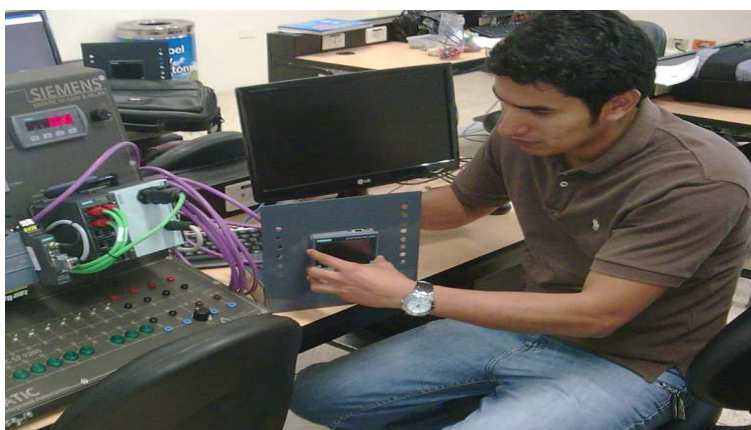
Figura 4.19: SENTRON PAC 3200 insertado en panel frontal. Fuente: Autores del documento
