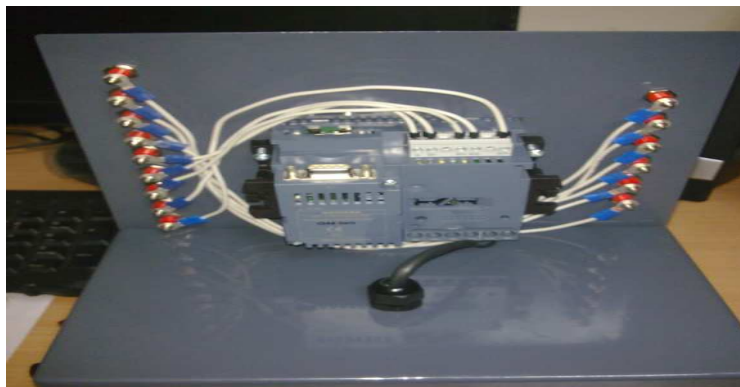
Figura 4.25: Cableado de entradas y salidas del equipo SENTRON PAC 3200 Fuente: Autores del documento
