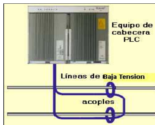
Figura 4. 6 Esquema de conexión de Cabecera PLC
