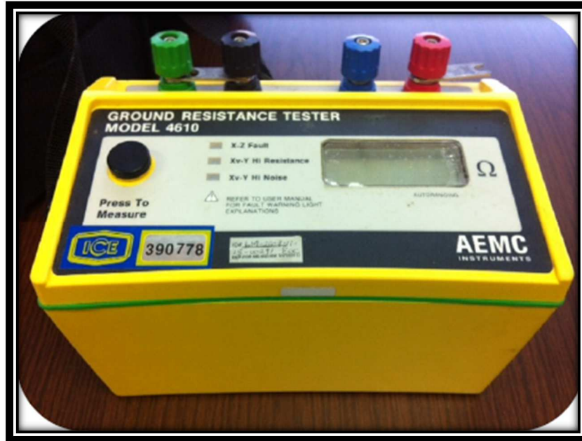
Figura 2.11 Ground resistance tester Fuente: Monterroso, P. (2013)
