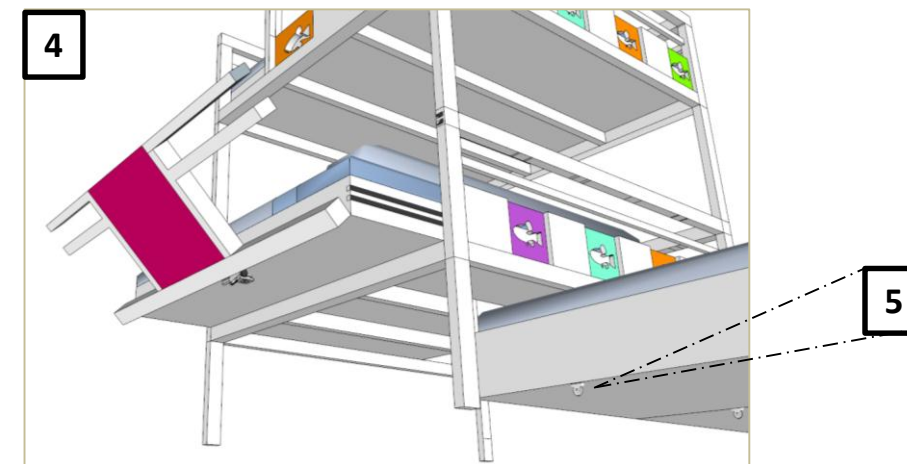
DESLIZAMIENTO DE LA SEGUNDA CAMA
