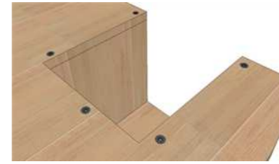
1. Fijación de tablero por medio de tornillo negro 1" de cabeza plana
