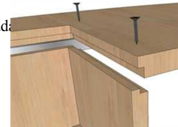
2. Unión de tableros por medio de ensamble a media madera
