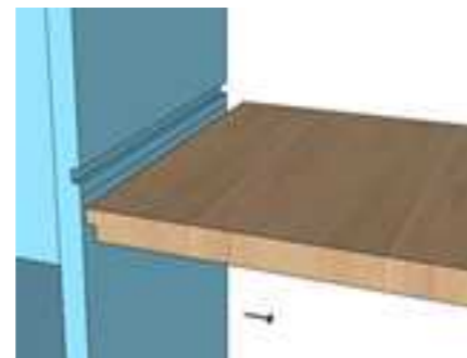
Fijación de repisas por medio del ensamble a media madera
