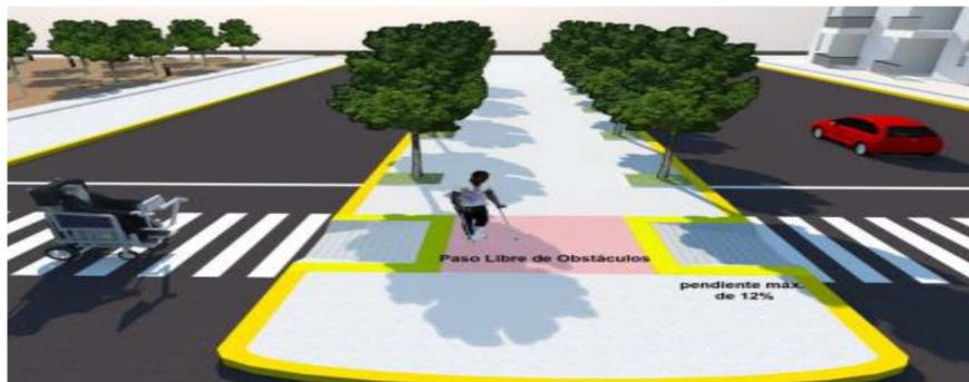
Figura 31. Detalle de calzadas y parterre central en donde el desnivel existente entre estas se salva mediante vados.
