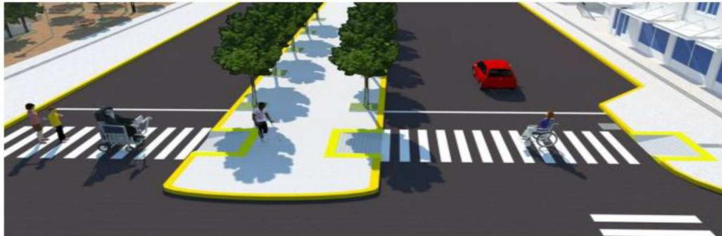
Figura 30. Vista de dos vías con parterre central en donde se salva mediante vados el desnivel existente entre el parterre y la calzada.
