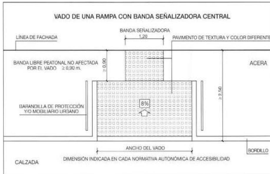
Figura 89. Vado de una rampa. Tomado de “Construmática”
