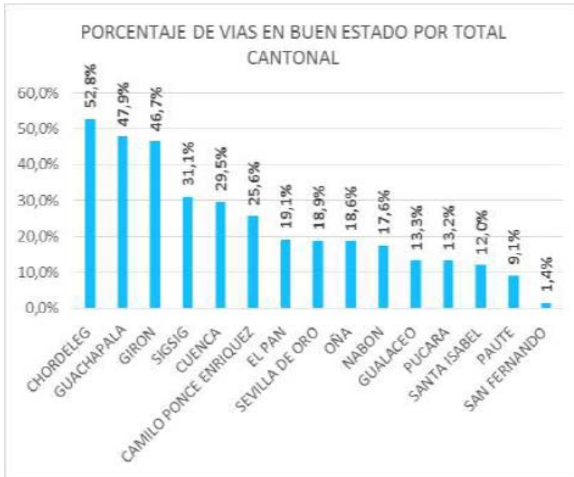
Figura 12. Porcentaje de vías en buen estado por total cantonal. Adaptado de Gobierno Provincial del Azuay, PDOT Azuay 2015 – 2030.
