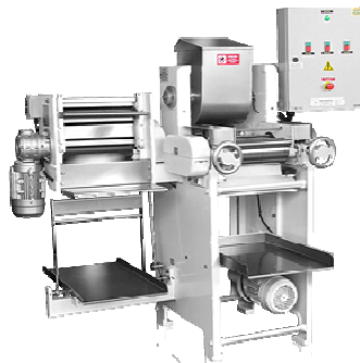
Máquina combinada - amasadora, sobadora y cortadora
