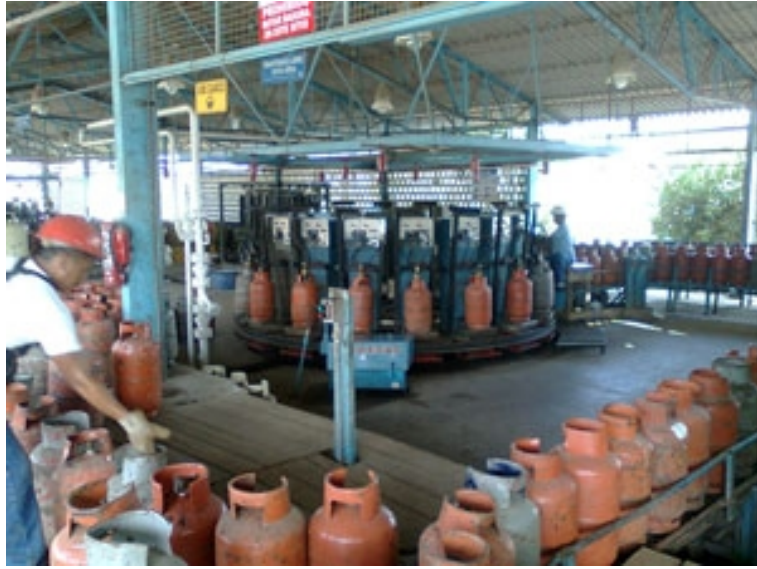
Foto 9 – Llenado de GLP en cilindros de 15kg en el Carrusel
