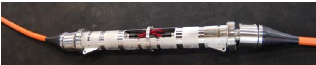
Figura 3. 13: Conectores de la Subestación Submarina (USP) Fuente: (Technologies, Underwater Substation Underwater Substation, 2008)
