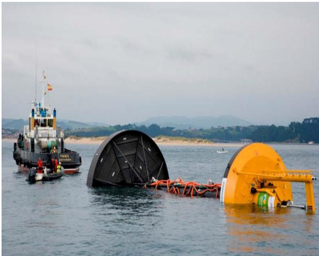
Figura 3. 7: Remolque del Dispositivo PB150 en el mar de Escocia Fuente: (Technologies, Power Buoy, 2011)
