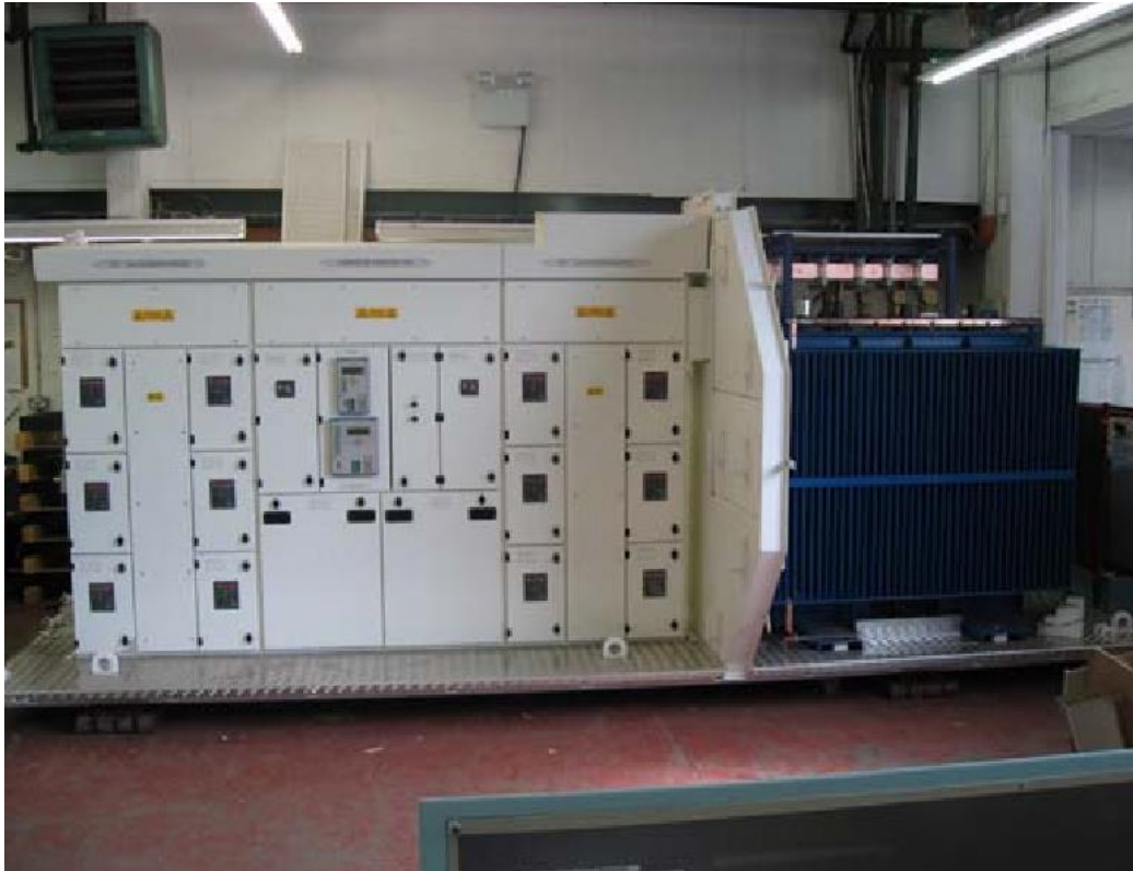
Figura 3. 11: Estructura Interna de la Subestación Submarina Fuente: (Technologies, Power Buoy, 2011)
