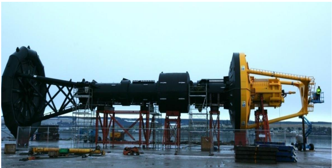
Figura 3. 4: Dispositivo Power Buoy PB150 previo a la instalación en el mar de Escocia
