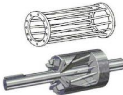
Figura 2. 33: Rotor Jaula de Ardilla Fuente: (Martos, Shu, & Valhondo, 2012)
