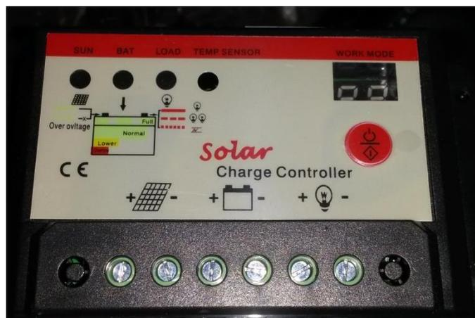
Figura 3. 30: Controlador de carga de 10A que se instaló.
