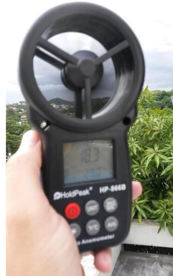
Medición realizada con el anemómetro 18.3km/h
