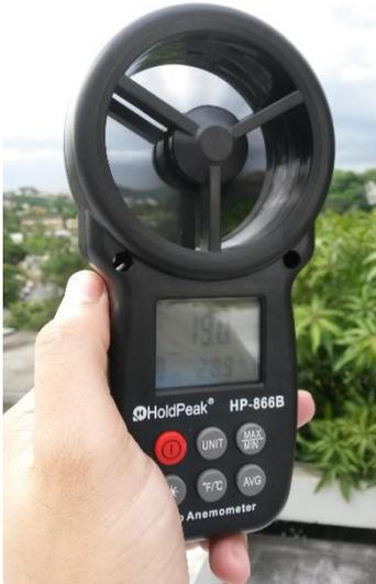
Medición realizada con el anemómetro 19km/h
