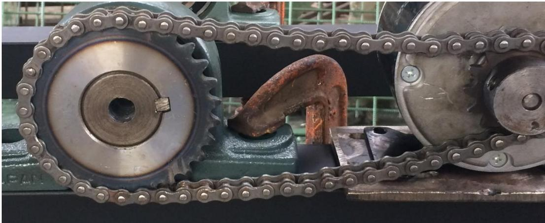
Figura 3. 19: Cadena seleccionada para el sistema de transmisión.
