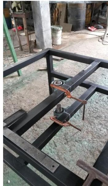
Posicionamiento de los sistemas de rodamientos.
