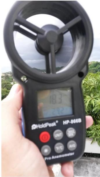
Medición realizada con el anemómetro 18.3km/h
