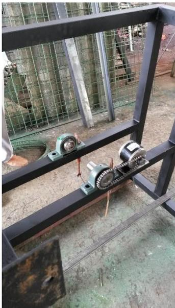
Centrado de los ejes del motor y de la catalina del eje principal.
