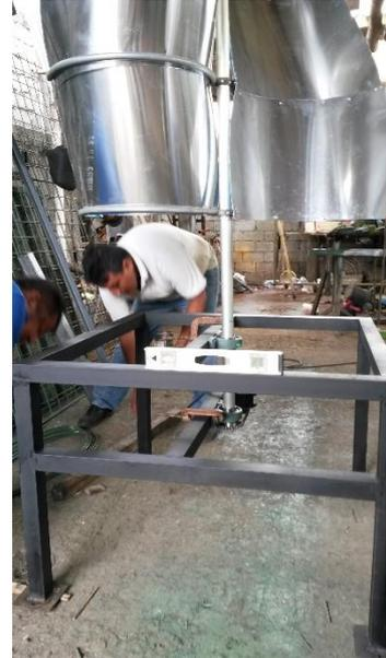
Centrado de la turbina eólica a los rodamientos.
