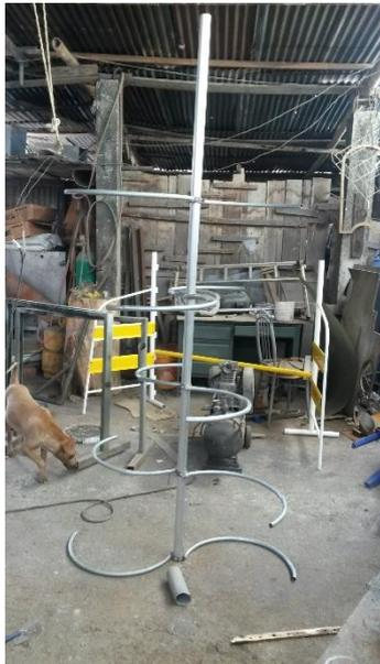
Acoplamiento de los segmentos "S" al eje de la turbina eólica.
