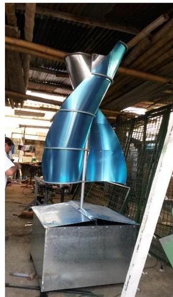
Acabado de la base del aerogenerador.
