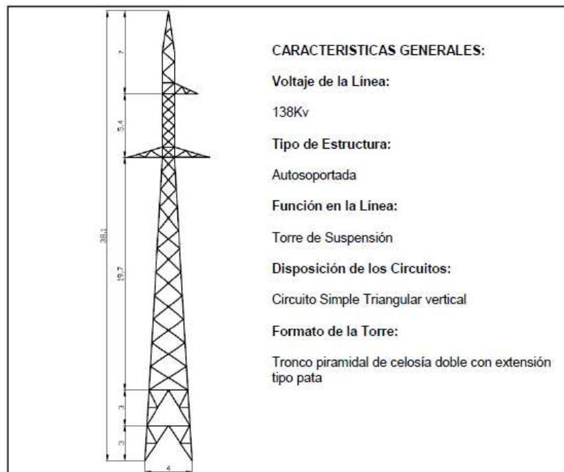
Figura 3. 14: Torre de suspensión circuito simple de 38.1m
