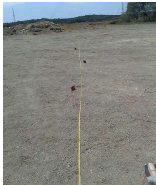
Metodo de wenner aplicado para encontrar la resistividad del terreno
