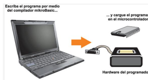
Figura 2. 10 Conexión del PC al microcontrolador Fuente: (Milan Verde, 2010)
