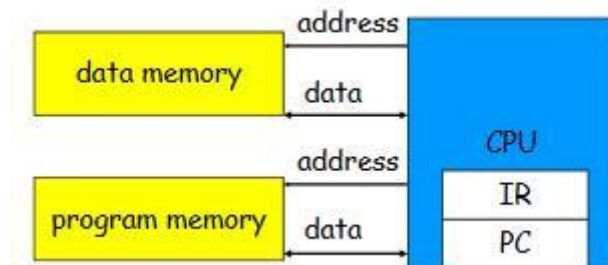
Figura 2. 7: Diagrama de bloques del concepto de HARVARD. Fuente: (Chenyang, 2014)
