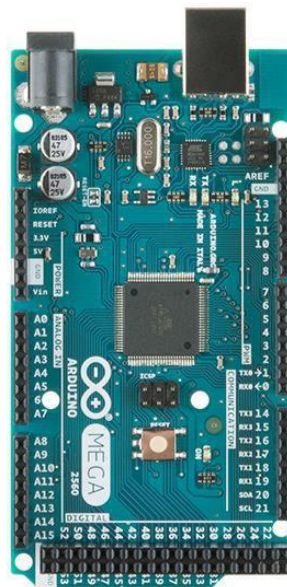
Figura 2. 14: Tarjeta Arduino Mega incorporado el microcontroladorATMega 2560. Fuente: (Sparkfun, 2017)
