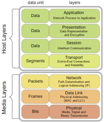
Figura 2. 15: Niveles del modelo OSI Fuente: (Saga, 2016)
