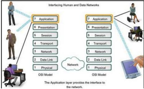
Figura 2. 22: Capa de aplicación del modelo OSI
