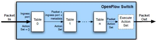
Figura 3. 14: Empaquetado en el Switch OpenFlow Elaborado por: (The Open Networking Foundation, 2011)
