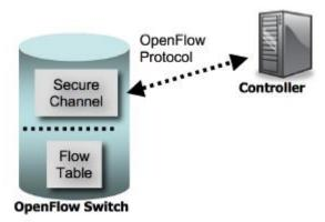
Figura 3. 13: Switch OpenFlow comunicándose con un controlador Elaborado por: (The Open Networking Foundation, 2009)
