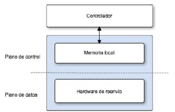
Figura 2. 26: Dispositivo conectado en capa de infraestructura
