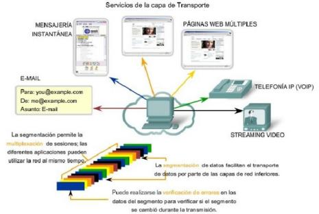
Figura 2. 19: Capa de transporte del modelo OSI Fuente: (Eagle90, 2009)
