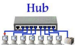
Figura 2. 8: Hub interconectado estaciones de trabajo Fuente: (Hunda, 2016)
