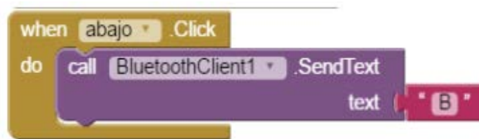
Figura 3. 19: Diagrama de bloque para caso 1 (botón de reversa presionado). Elaborado por: Autores
