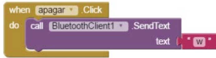
Figura 3. 24: Diagrama de bloque para desactivación de arma del robot Warbot. Elaborado por: Autores.
