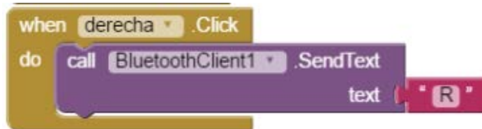
Figura 3. 21: Diagrama de bloque para caso 2 (botón girar derecha presionado). Elaborado por: Autores.
