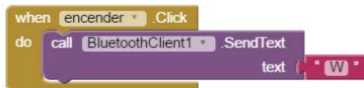
Figura 3. 23: Diagrama de bloque para activación de arma del robot Warbot. Elaborado por: Autores.
