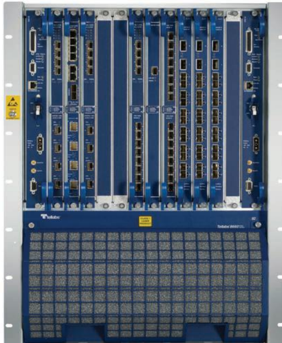
Figura. 3.3: Enrutador Inteligente “Tellabs 8660” Fuente: (Tellabs, 2012)
