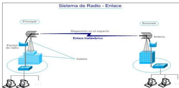
Figura 2.1: Sistema de Radioenlace
