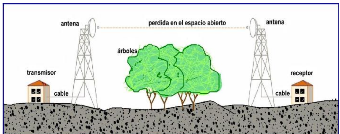
Figura 2.5: Trayectoria Entre el Transmisor y el Receptor Fuente: (Pulgar C. L., 2012)
