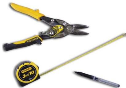
GRÁFICO 56 Herramientas para corte de perfiles metálicos
