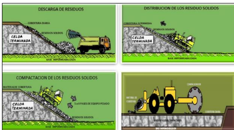
FIGURA 4: Operación de un relleno sanitario
