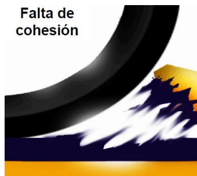
Figura 2.11: Falla por cohesión entre el asfalto y el agregado
