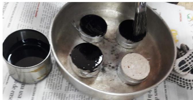
Figura 3.7: Colocación de asfalto en pastillas
