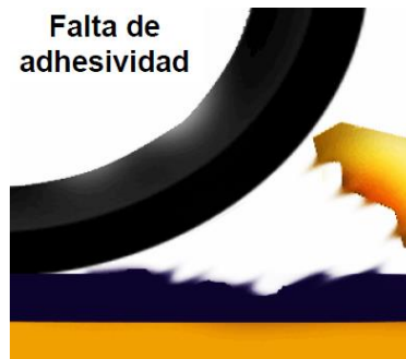
Figura 2.10: Falla por adhesión entre el asfalto y el agregado
