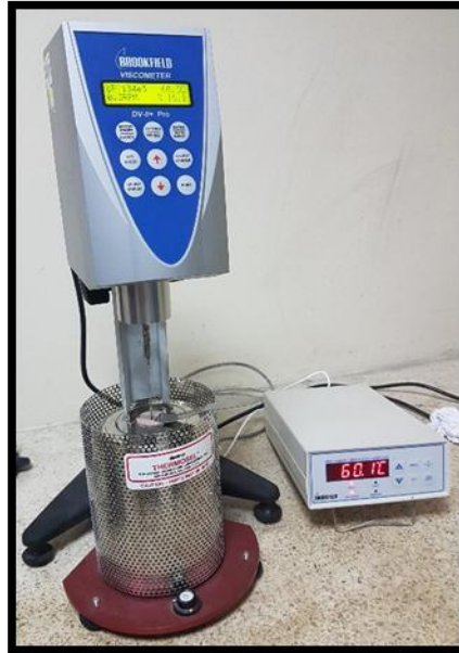
Figura 7. Ensayo en el Viscosímetro Brookfield a 60°C. Fuente: Autores
