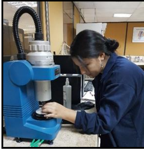
Figura 15. Ensayo en el reómetro de corte dinámico (DSR).
