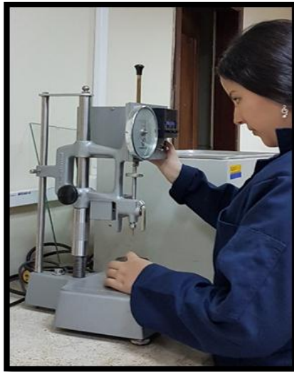
Figura 8. Ensayo de penetración.
