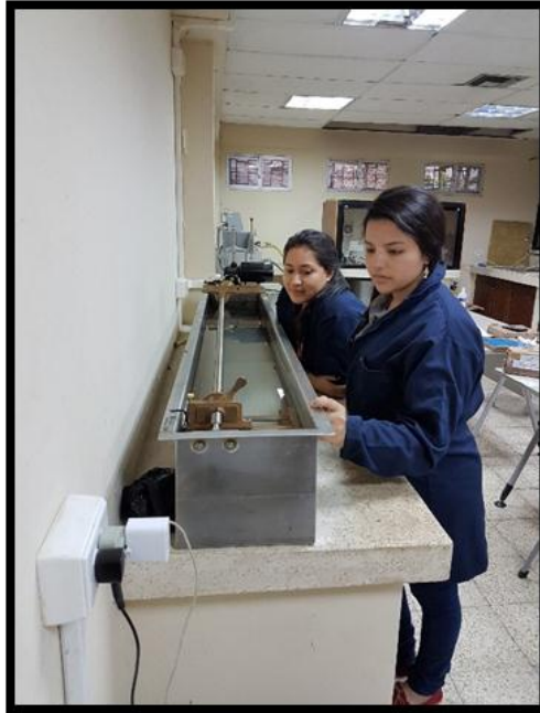
Figura 11. Ensayo de Ductilidad a 25°C. Fuente: Autores
