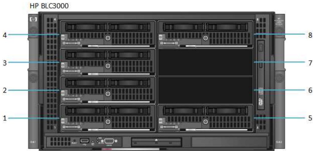
Figura 14: BladeSystem BLC3000 Fuente: Facultad de Ingeniería
