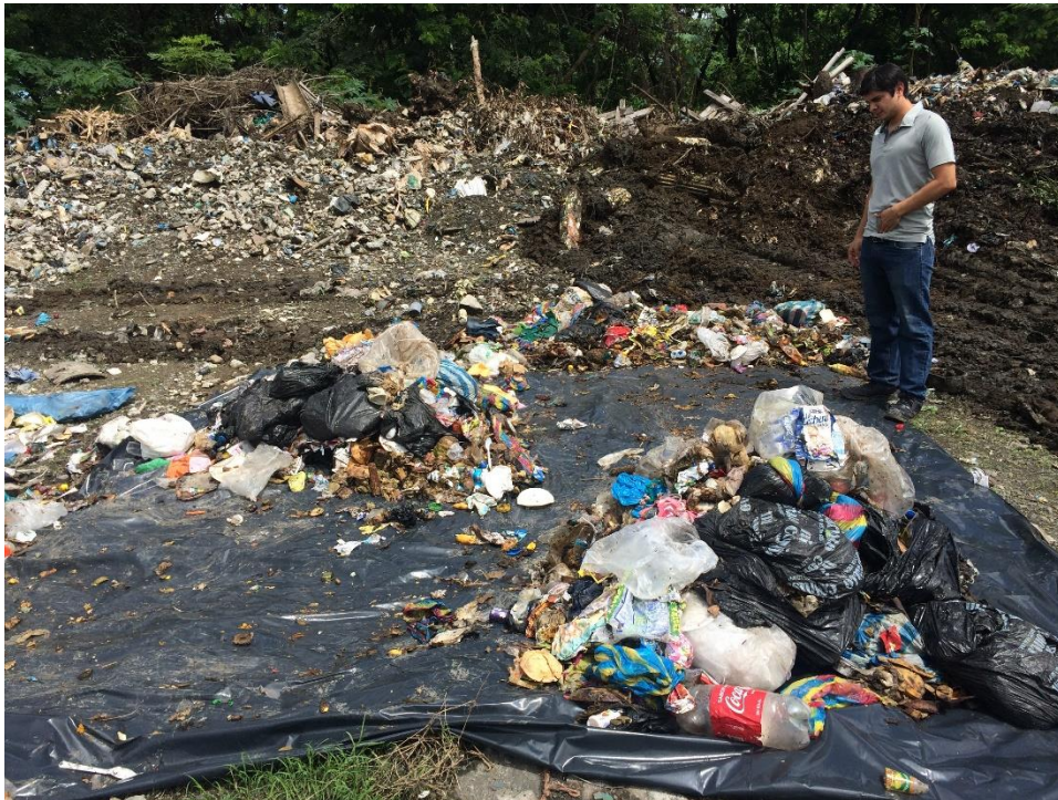
Ilustración 29: Aplicación del método del cuarteo.
