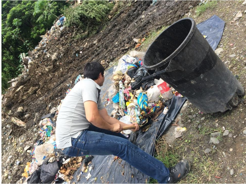
Ilustración 32: Llenado de recipiente de 100 litros para determinación de la densidad.
