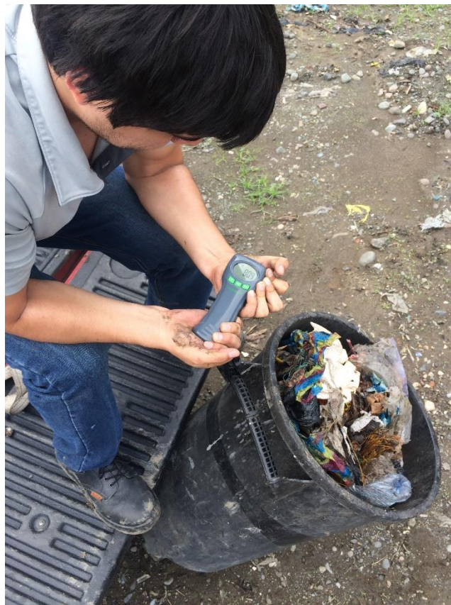
Ilustración 33: Pesaje el recipiente de 100 litros de capacidad lleno de residuos sólidos. Determinación de la densidad.
