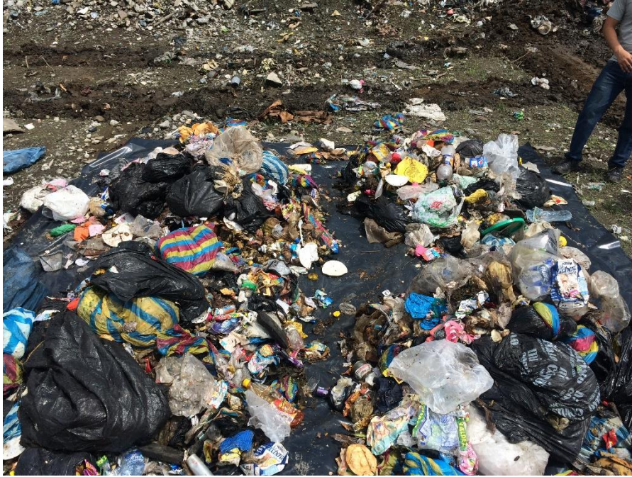
Ilustración 28: Cuarteo de los residuos sólidos.
