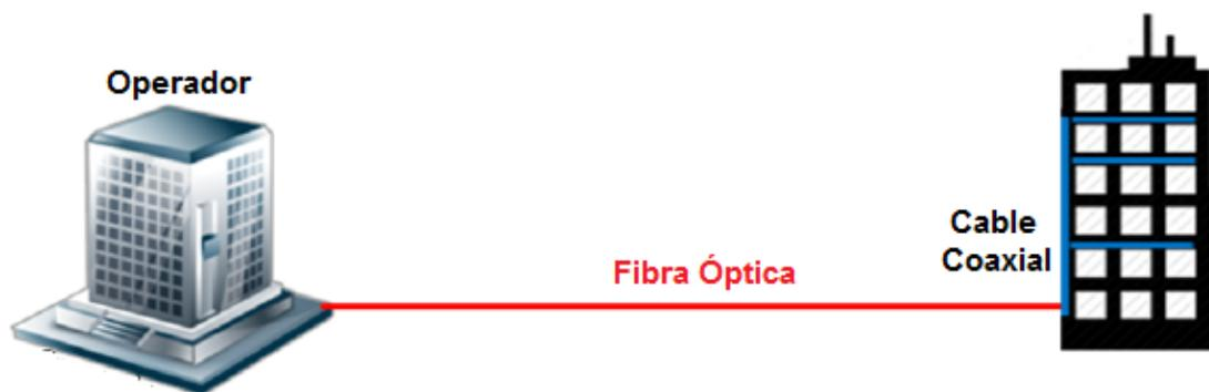
Figura 2. 16: Esquemático de la topología FTTB.
