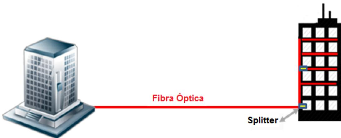
Figura 2. 15: Esquemático de la topología FTTA.
