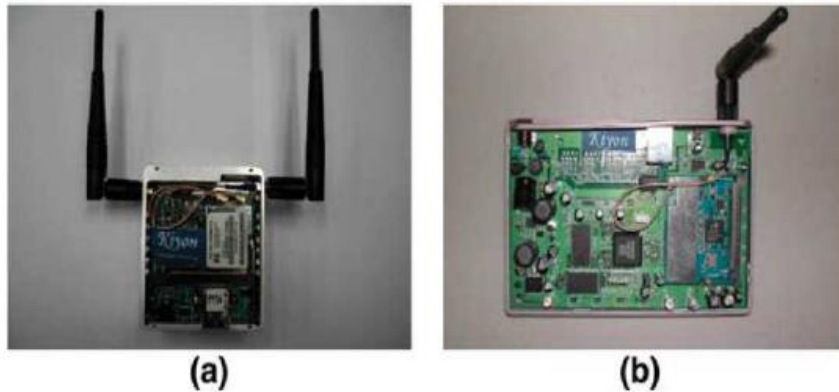
Figura 2. 1: Ejemplos de enrutadores de malla basados en diferentes sistemas embebidos: (a) PowerPC y (b) ARM.
