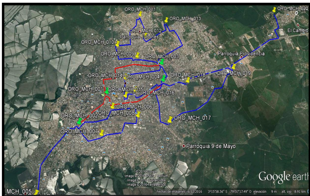
Figura 4. 6: Anillos de enlaces de FO sobre la red IP-RAN Elaborada por: La Autora (Aplicación Google Earth).
