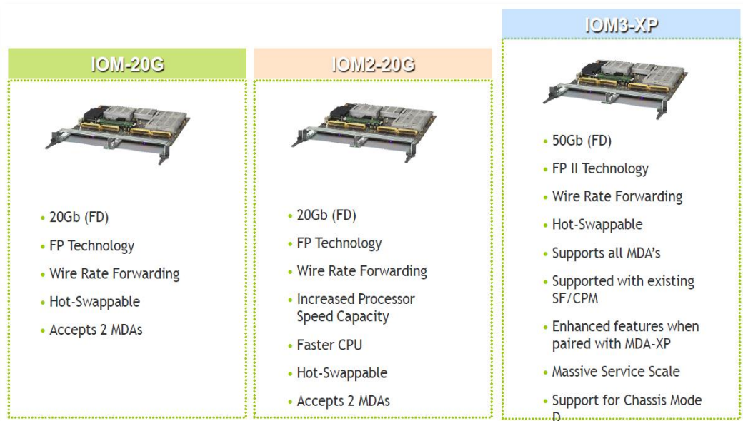
Figura 3. 14: Modelos de tarjetas IOM para router 7750 SR-12 Fuente: (Alcatel-Lucent, 2014)
