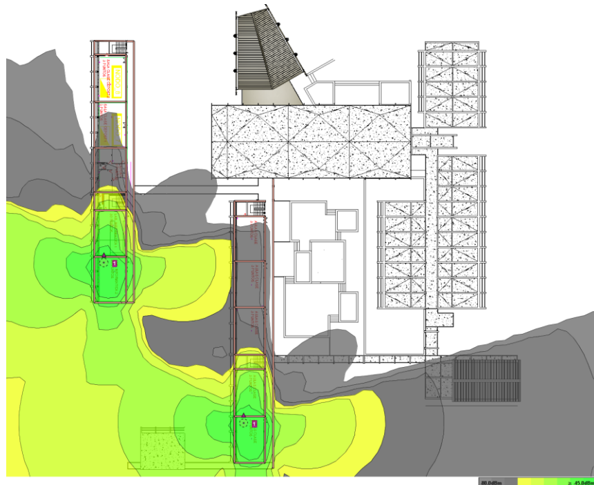
Figura 3. 15: Análisis de cobertura en la segunda planta alta de la Unidad Académica de Ciencias Agropecuarias. Elaborado por: El Autor.
