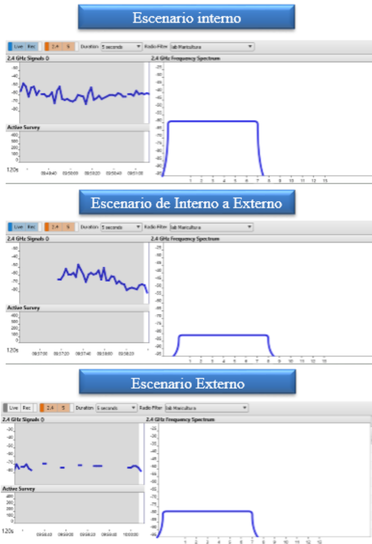
Figura 3. 18: Análisis del espectro de frecuencia de dispositivos domésticos Elaborado por: El Autor.
