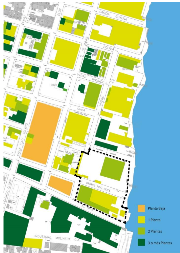
Figura 11 Plano del entorno construido del sector.
