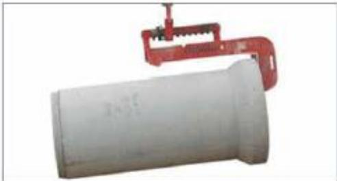
**Figura 34: Uso de pinza para maniobra de descarga de tuberías de diámetros mayores**
