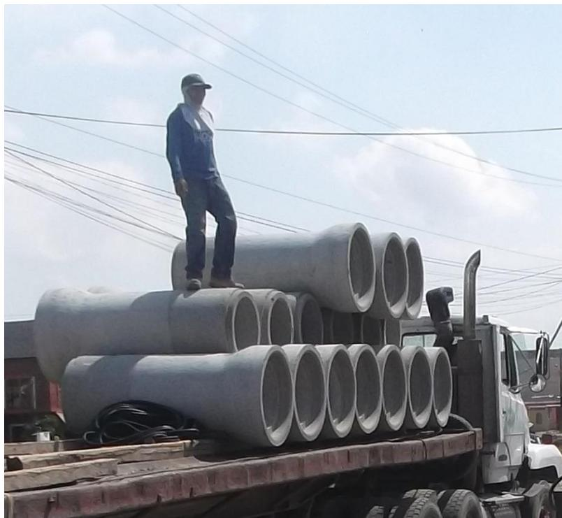
***Figura 37: Correcta estiba de tubos apoyando la campana en la espiga***
