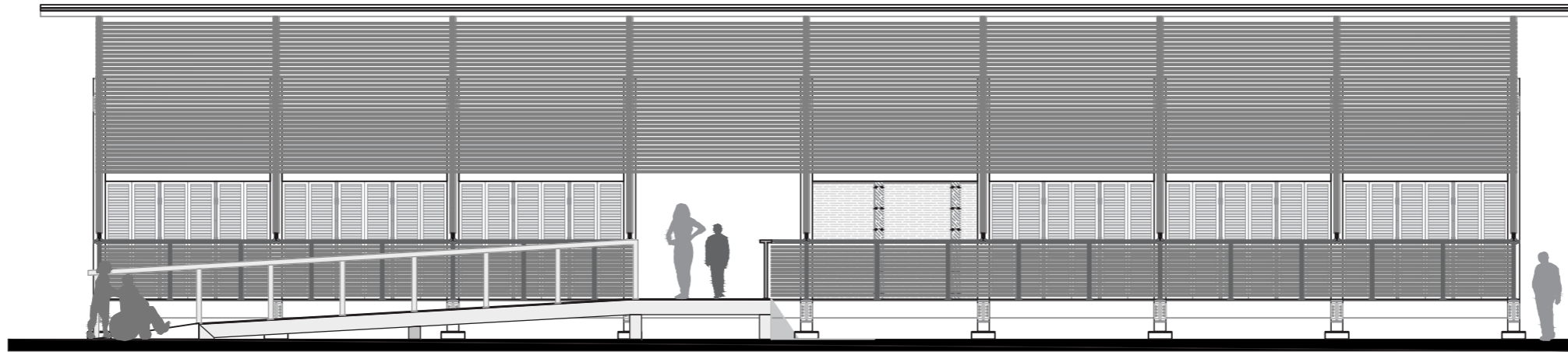
BLOQUE A PRE-ESCOLAR: ELEVACIÓN SUR ESC: 1:100m
