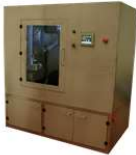
Figura 33. Máquina de Lavado Secado de Neumáticos
