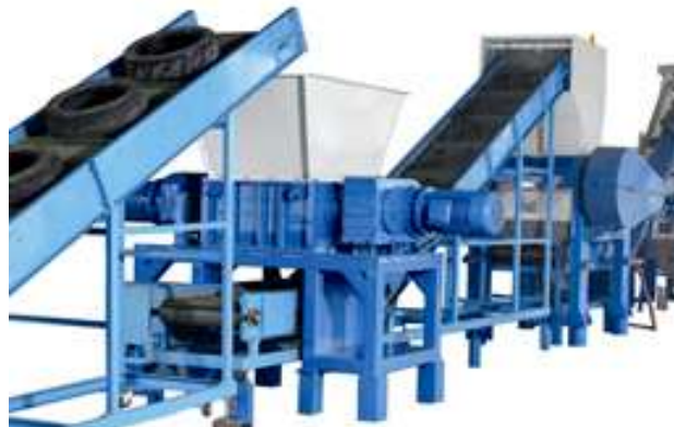
Figura 34. Máquina de Pre Triturado y Cinta Transportadora
