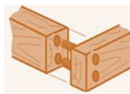
JUNTAS DE MADERA CON TOPES Y TARUGOS
