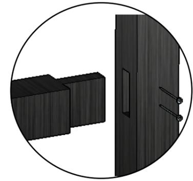
Detalle 12: Ensamble de Caja y espiga usada en las patas delanteras y travesaño.
