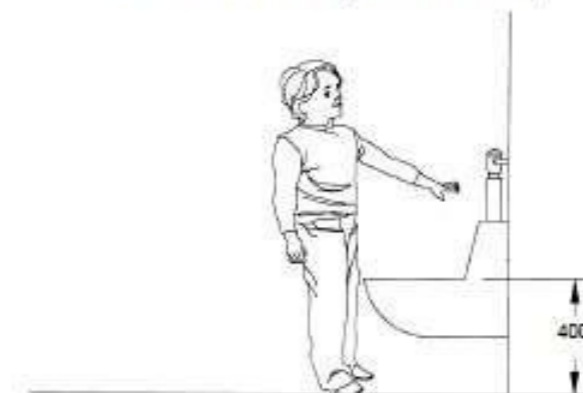
FIGURA 12. Urnarios (Dimensiones en mm)
