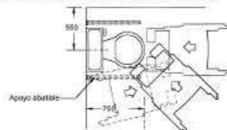
FIGURA 9. Localización del inodoro. (Dimensiones en mm)
