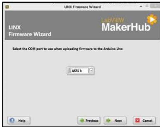
Figura 3. 43: Configuración de puerto COM Fuente: (Hackster, 2016)
