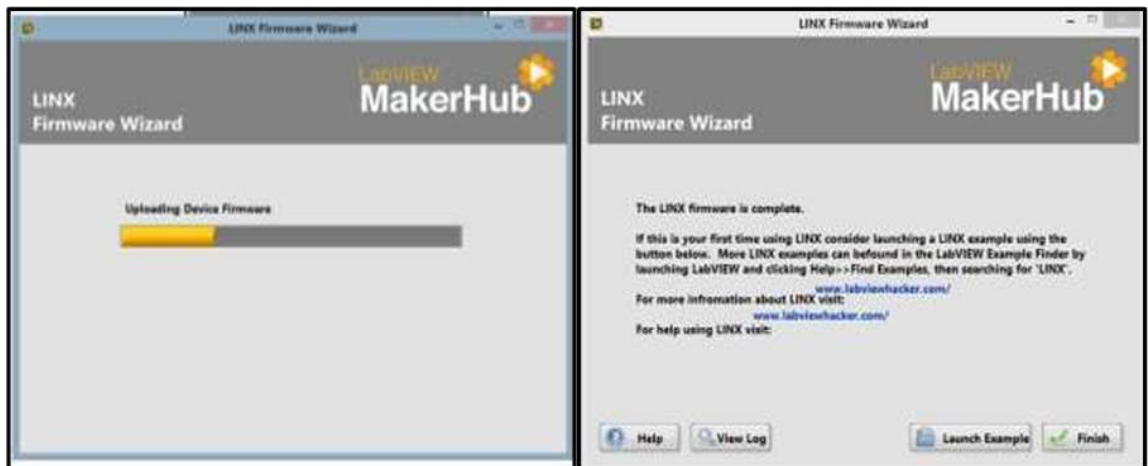
Figura 3. 44: Carga del software para la comunicación entre LabView y Arduino Fuente: (Hackster, 2016)
