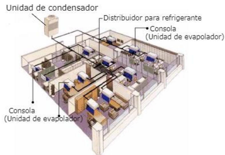
Figura 18. Sistema de aire acondicionado centralizado
