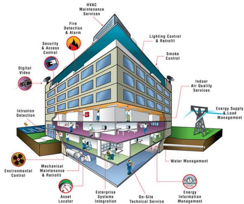
Figura 2. Características de Edificio Inteligente
