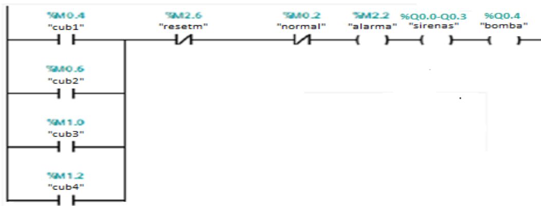
Figura 3.31. Activación marca alarma y salidas %Q0.0-Q0.4
