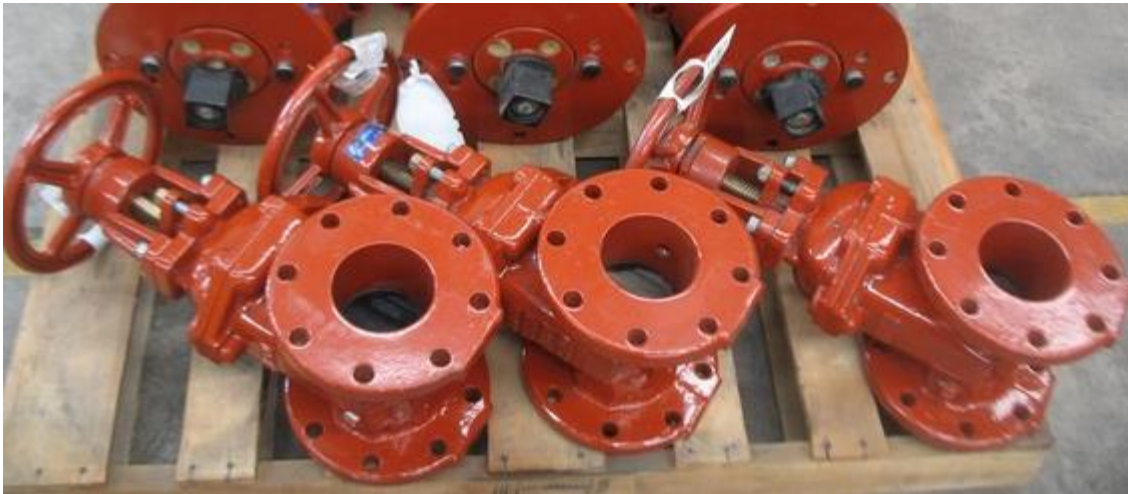
Figura 3.18 Válvulas contra incendio
