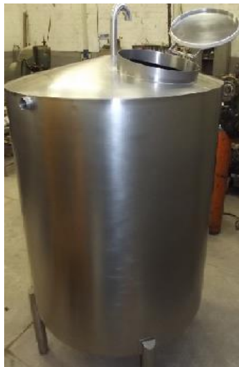
Figura 3.11 Tanque de almacenamiento de acero inoxidable
