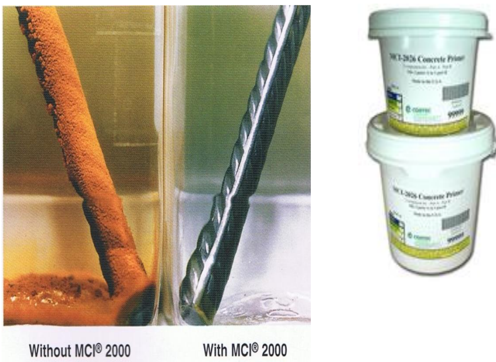
Figura 27. Utilización del inhibidor de Corrosión en el Acero de Refuerzo.
