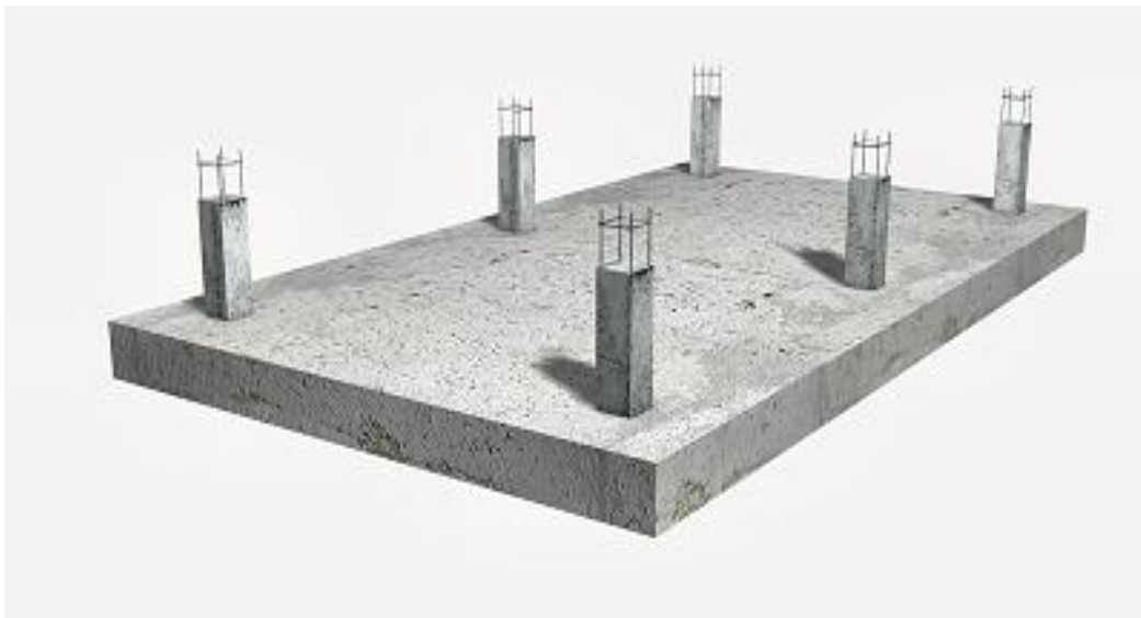
Figura 9. Losa de Cimentación
