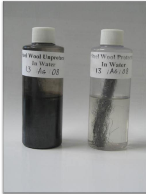
Figura 41. Fases de la Corrosión
