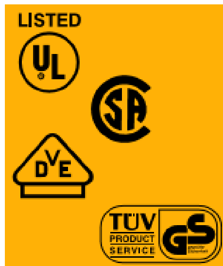
Figura 2. 11: Símbolos y siglas de laboratorios de prueba. Fuente: (Fluke Corporation, 2003)
