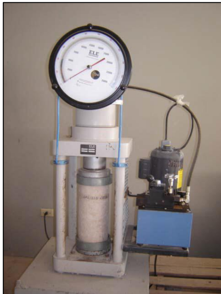
Gráfico 12: Máquina empleada para ruptura de cilindros probados a compresión
