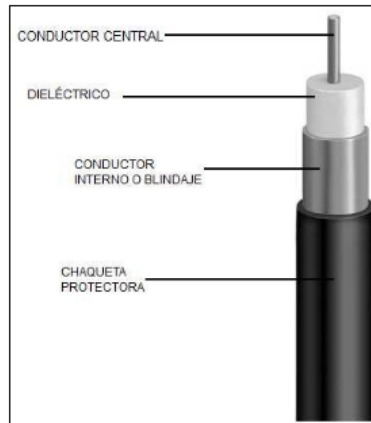
Figura 2. 14: Cable coaxial 75Ω. Fuente: (Ruíz, 2013)
