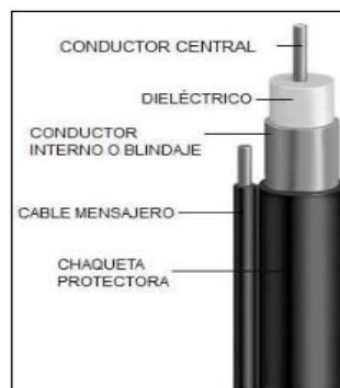
Figura 2. 15: Cable coaxial 500Ω. Fuente: (Ruíz, 2013)
