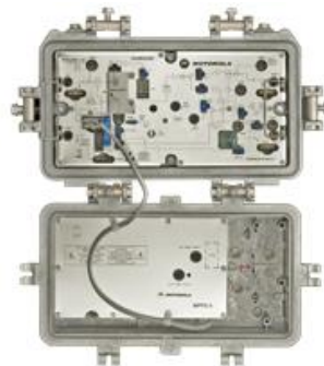
Figura 2. 18: Amplificador MB. Fuente: (Company., 2016)
