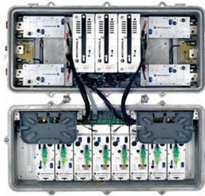
Figura 2. 17: Nudo óptico Motorola. Fuente: (Company., 2016)
