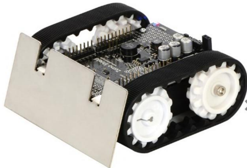
Figura 2. 26: El robot Pololu Zumo con plataforma Arduino, Fuente:(Pololu, 2016).
