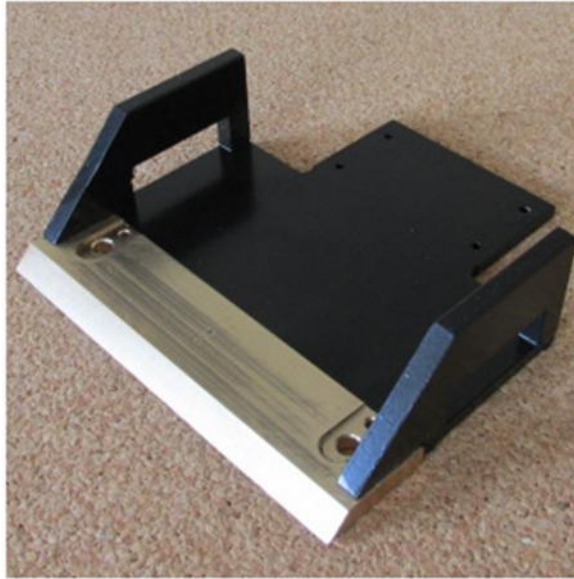
Figura 3. 13: Diseño estructural del robot minisumo Elaborado por: Autores
