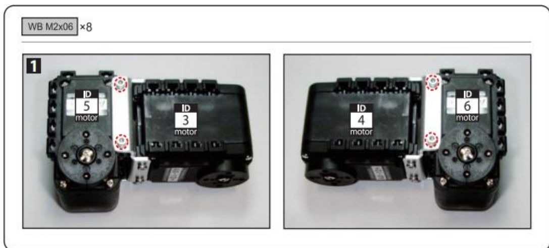
Figura 3. 12: Fijación de servomotores que conformaran los brazos del robot.
