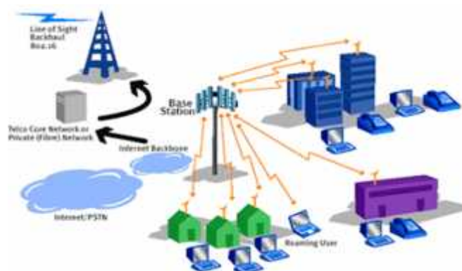
Figura 2.1 Estructura de una red inalámbrica
