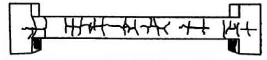
Fig. #26 Viga con fallas de adherencia por cortante
