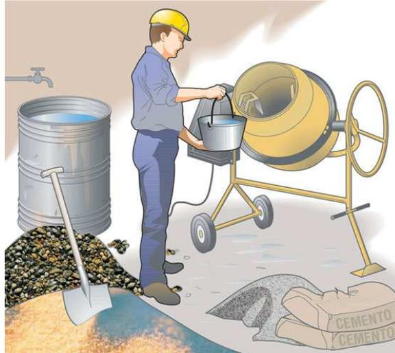
Fig. #55. Dosificación del Hormigón. (TARINGA, 2013)
