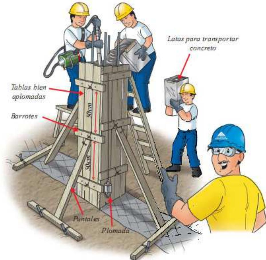
Proceso de vaciado y vibración en columnas de hormigón armado
