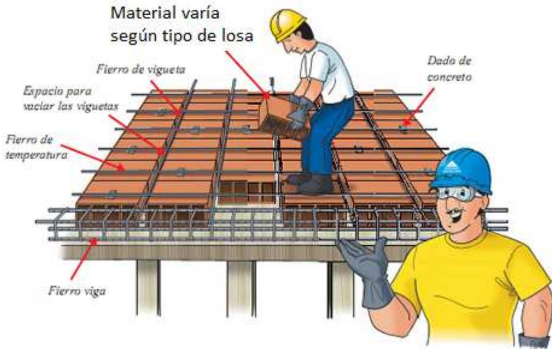
Estructuración de una losa de hormigón armado (TARINGA, 2013)
