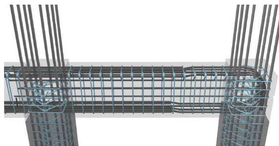
Fig. #1 Marco estructural viga-columna (LLOPIZ, 2014)
