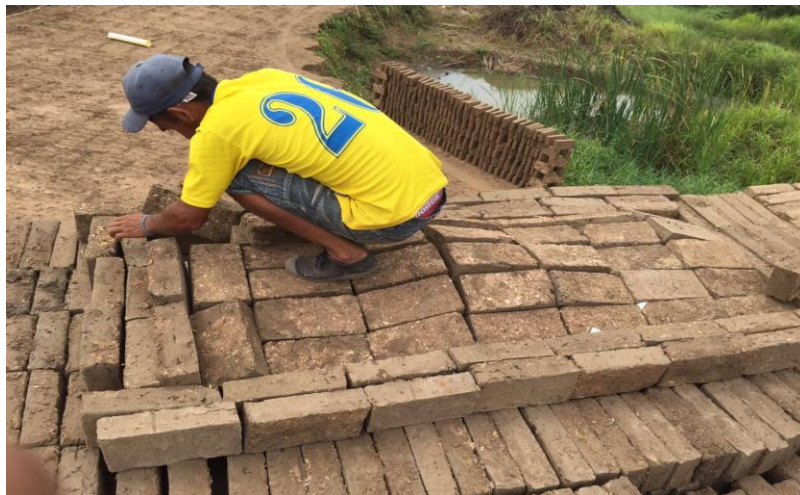
Ilustración 10. Colocación de las arenas y gravas de arcillas con adiciones de lodos residuales en el horno artesana
