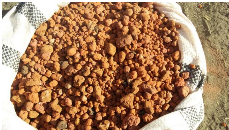
Ilustración 12. Compuestos de arena más grava de arcilla con adiciones de lodos residuales cocidos
