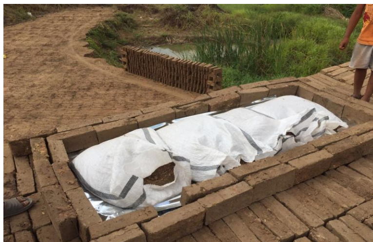
Ilustración 11. Disposición de los compuestos de arena más grava de arcilla con adiciones de lodos residuales en horno artesanal
