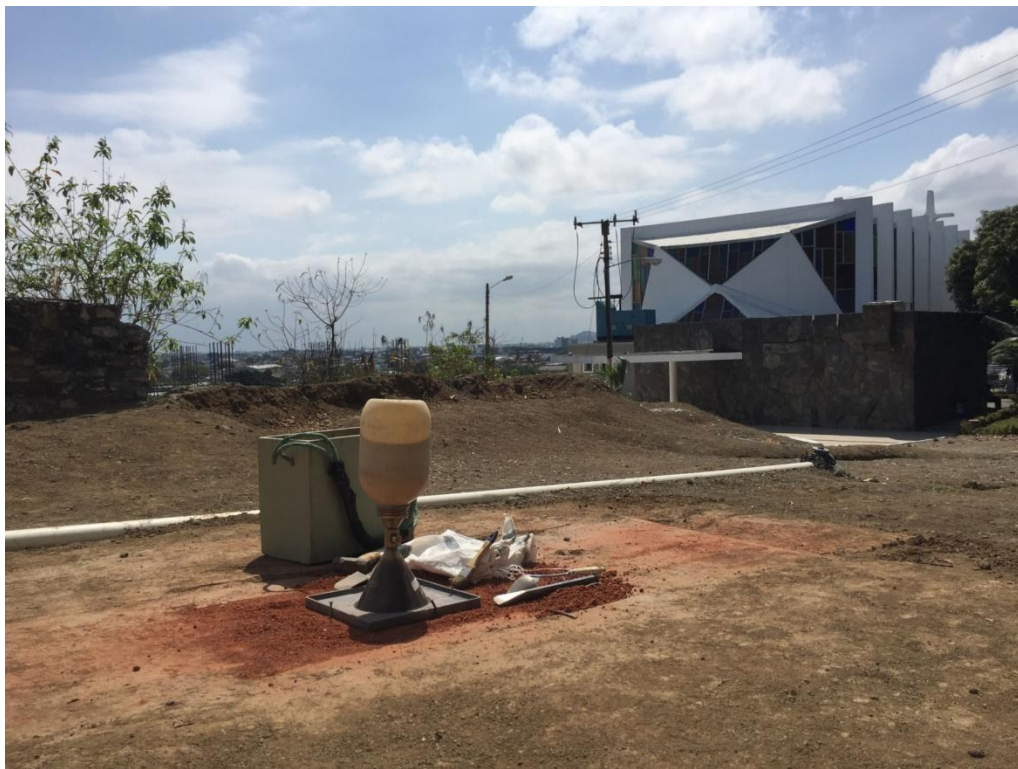
Ilustración 24. Densidad de los Suelos (Método del Cono y Arena)
