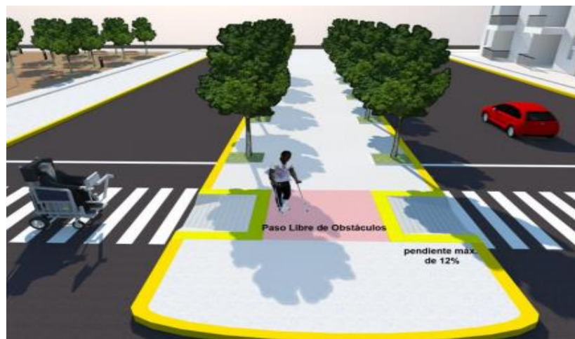
Figura 37. Detalle de calzadas y parterre central en donde el desnivel existente entre estas se salva mediante vados Fuente: Tomado de CONADIS, 2015
