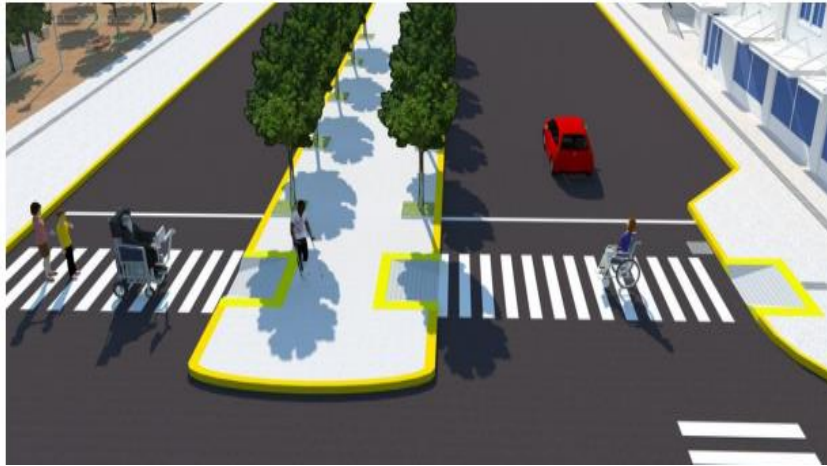
Figura 36. Vista de dos vías con parterre central en donde se salva mediante vados el desnivel existente entre el parterre y la calzada Fuente: Tomado de CONADIS, 2015
