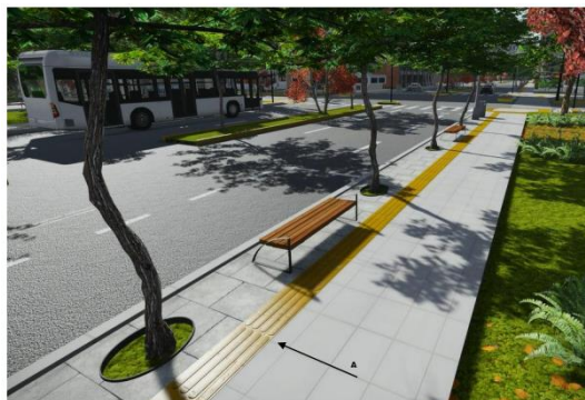
Figura 49. Uso de bandas podotáctiles guía en espacios urbanos Fuente: Tomado de CONADIS, 2015
